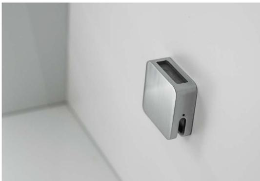
Sulla parete della cabina viene posizionato l'erogatore di vapore in acciaio che permette il rilascio del vapore all'interno della cabina. L'erogatore di vapore è collegato al generatore di vapore posto nel vano tecnico da un tubo flessibile attraverso il quale passa il vapore. Nella parte alta della cabina trova posto il sensore di temperatura.
